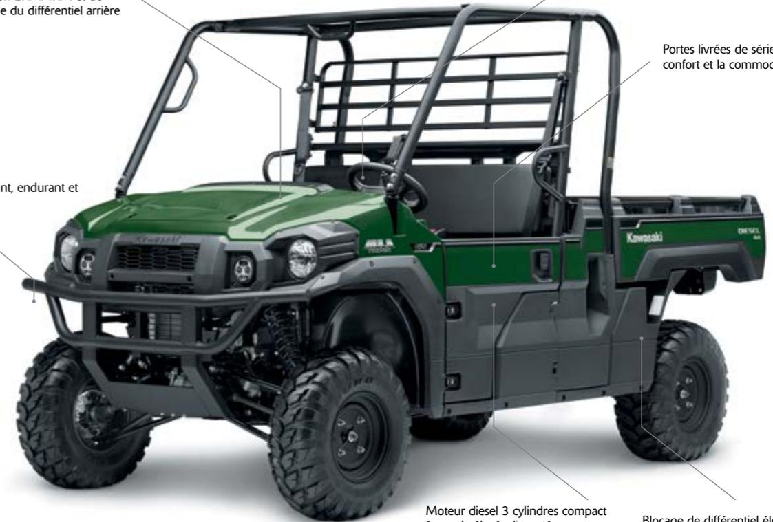
Moteur diesel 3 cylindres compact à couple élevé, alimenté par un réservoir de 30 litres
