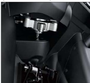
**EPS** - Le système de direction assistée électrique (EPS) de haute qualité de Kawasaki est sensible à la vitesse et offre une direction facile à basse vitesse. Dans le même temps, le soutien est réduit à mesure que la vitesse du véhicule augmente afin de resserrer la direction.
