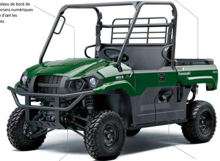
La suspension à double triangulation est utilisée à l'avant et à l'arrière afin que chacune des roues puisse franchir des obstacles avec un impact minimal sur le châssis
