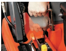
Pour nettoyer l'arrière du conduit.
