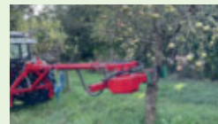
Stammschüttler hydraulisch Damit schütteln Sie bis zu 100 Bäume pro Stunde, ohne Hilfsperson. Bis 65 cm Stammdurchmesser.
