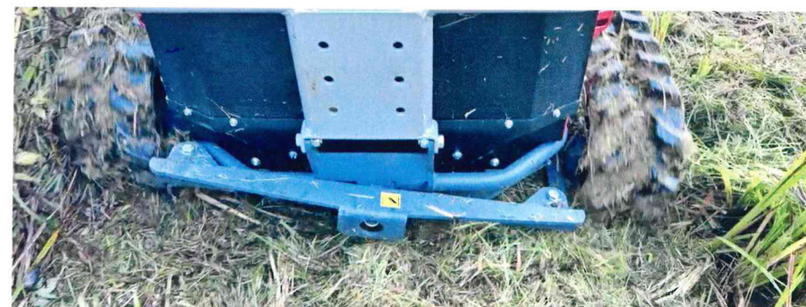
Ein spezielles Stabilitätssystem sorgt dafür, dass die Maschine immer vollen Kontakt mit dem Gelände hat.
