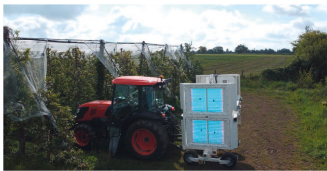
Mit UV-C-Strahlen soll die Widerstandsfähigkeit von Pflanzen gesteigert und der Ertrag verbessert werden können. Bild: Kubota
