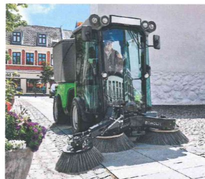
Kehrt auch in sehr engen Bereichen – ein dritter Besen erhöht die Arbeitsbreite
