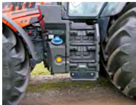
La nouvelle position des réservoirs de carburant et d'AdBlue ainsi que les marchepieds intégrés facilitent l'accès à la cabine.
