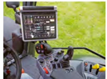
Le levier multifonction permet de commander la transmission et les fonctions hydrauliques.
