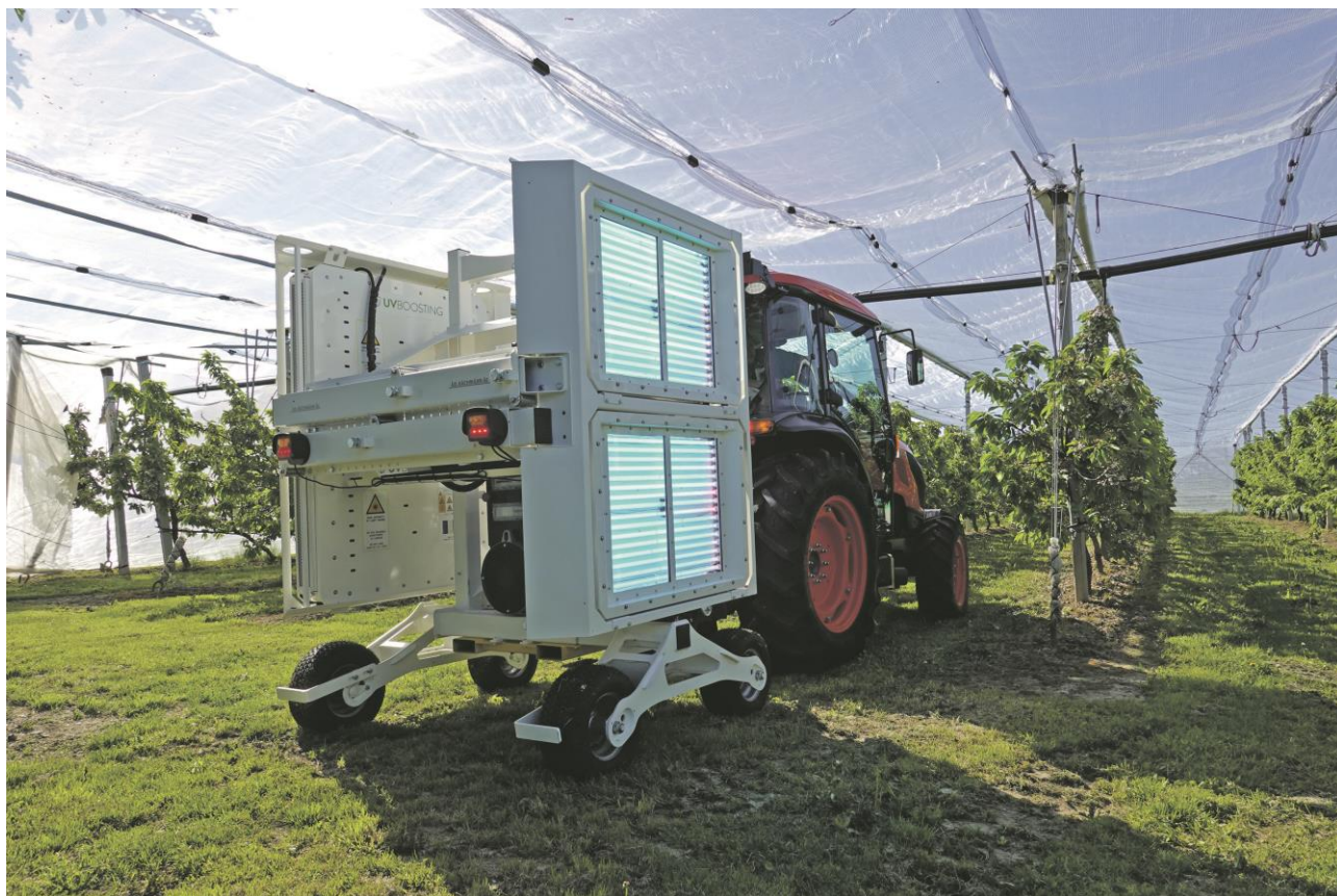
UV Boosting en utilisation pratique dans l'arboriculture : Kubota renforce son engagement dans cette technologie UV-C innovante. (Photo : Ad. Bachmann AG, Aaron Schmid)
